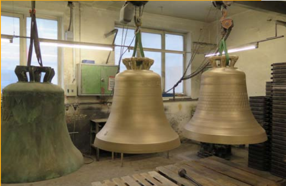
Bestandsglocke und zwei Glockenneugüsse für das Propsteigeläut (in der Glockengießerei Grassmayr), Foto: Firma Grassmayr
